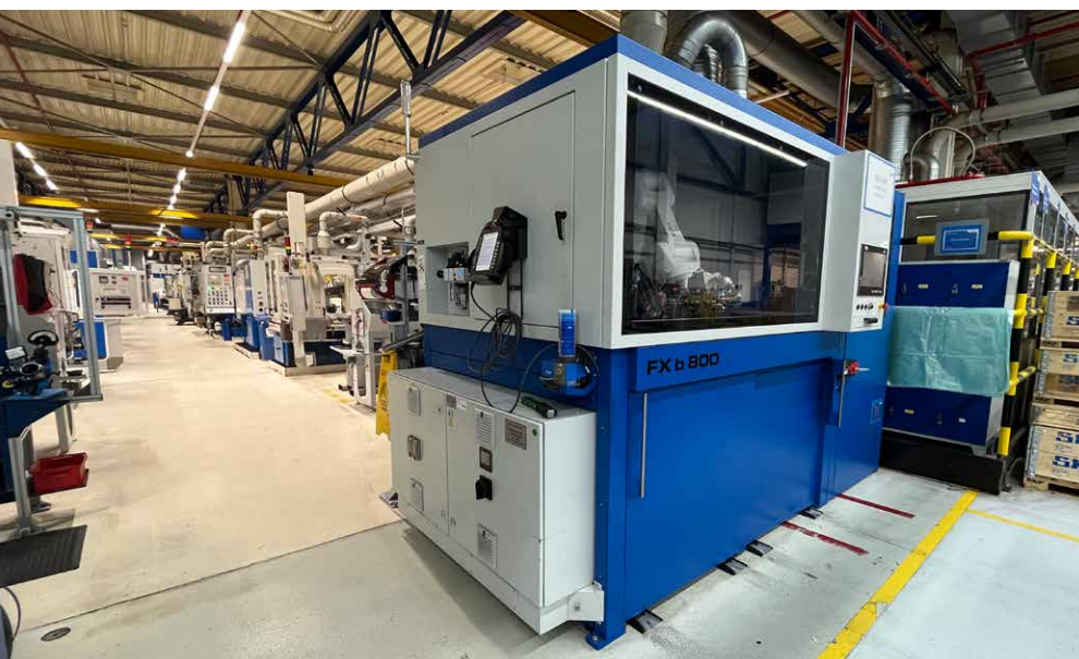
左图：封闭式单元设计与生产完美结合，大大降低了噪音。
